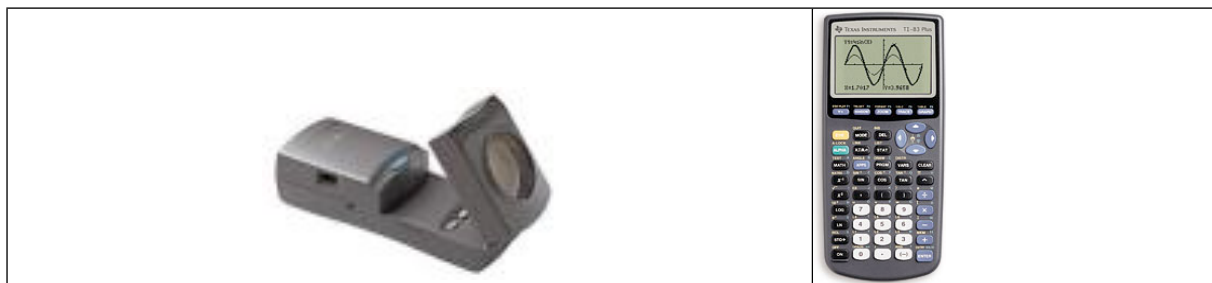
Figure 4. Le calculateur Based Ranger (à gauche) est un artefact conçu pour étudier les objets en mouvement : au moyen de l'émission d'ondes, le CBR rassemble les données de sa distance à l'objet en question. En se connectant à une calculatrice graphique (par exemple la TI83+, montrée sur la photo à droite), il est possible d'obtenir des graphiques espace-temps, vitesse-temps, etc.
